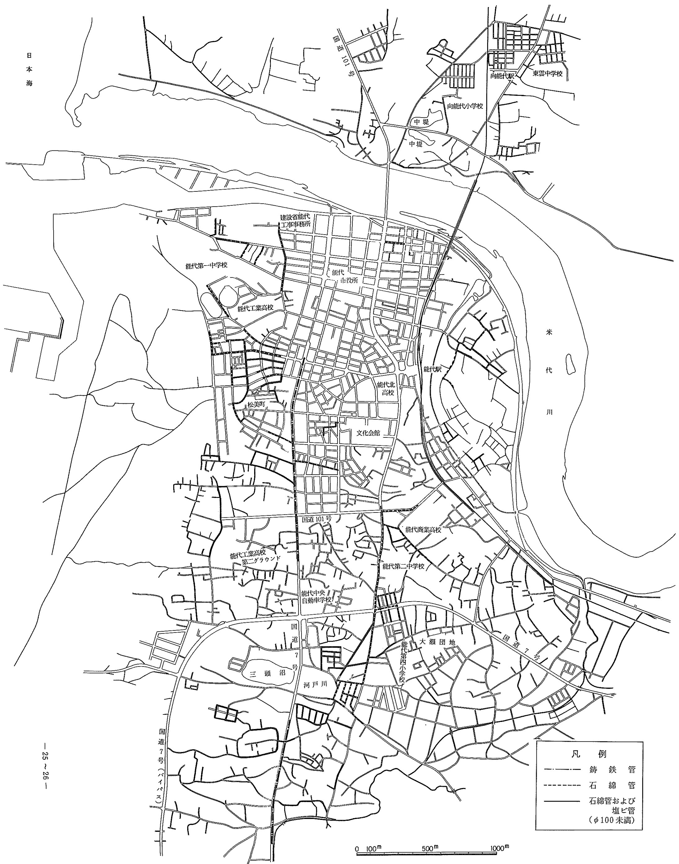
図 2.7 水道管被害箇所図
