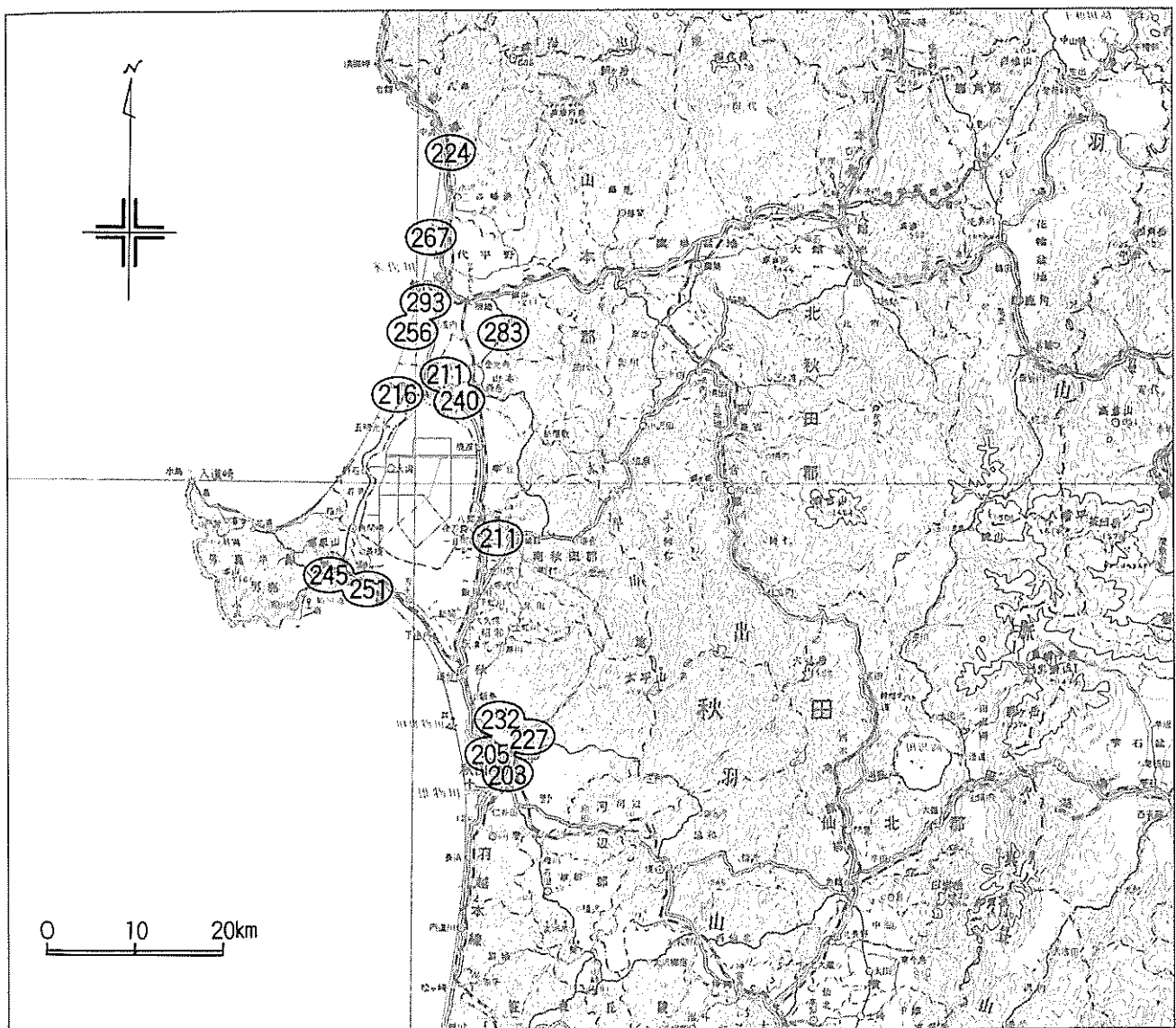
図 4 - 5 基石転倒率から推定した加速度分布 (単位: gal)
