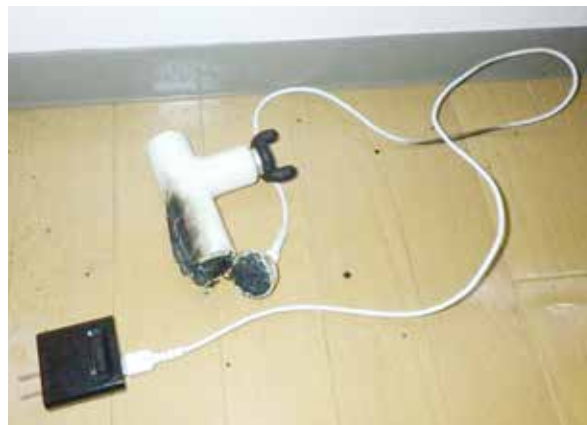
写真1 マッサージガン及びUSBケーブルの焼損状況を撮影
