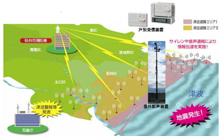
図9 津波情報伝達システム(イメージ)
