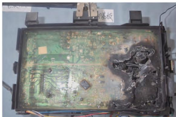
写真5：電装ケース及び制御基板の状況
