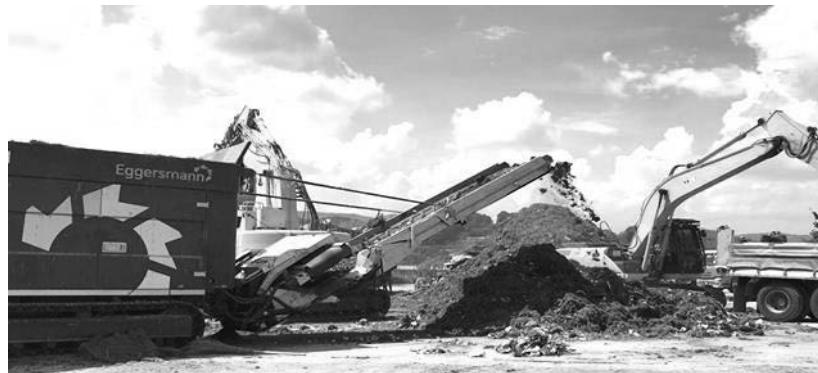
写真 2 倉敷市の 2 次仮置き場に配置された量専用の破碎機
