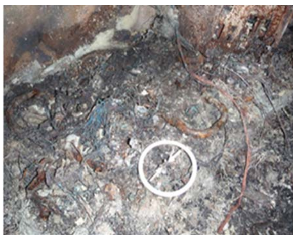
写真10 両刃溶断プラグ周辺
