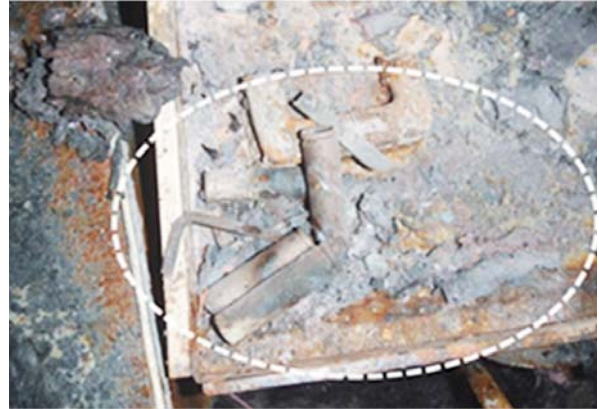
写真3 開口しているリチウムイオン電池
