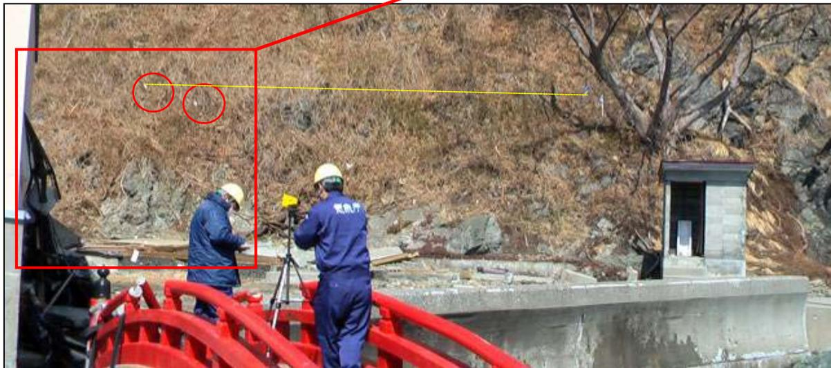
写真 5 津波の痕跡（宮古検潮所付近の傾斜地に漂着物が確認された、図 6 の 24）
