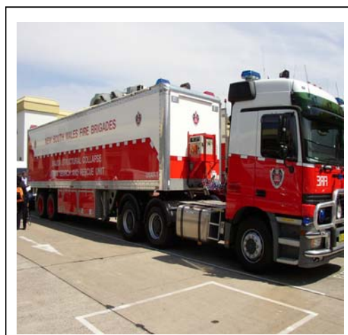
大規模建築物倒壊時の資機材運搬車
