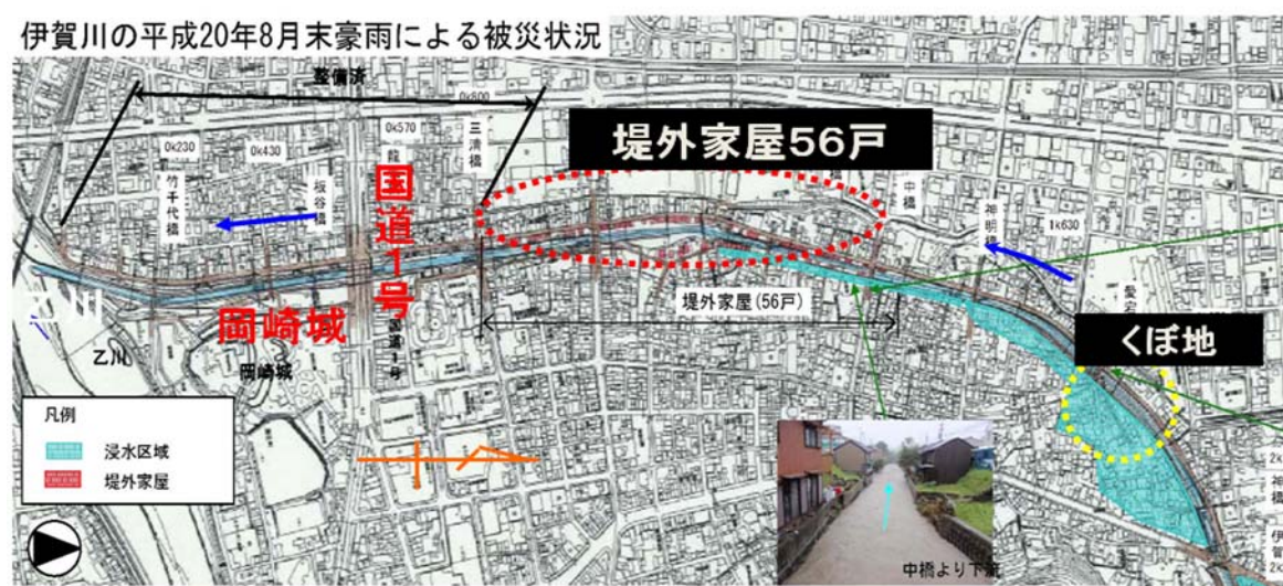
図 10.6.1 伊賀川の被害
