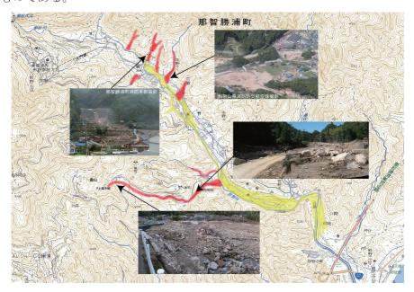
図4 那智勝浦町那智川流域の土石流の発生状況 土石流の範囲(概略)を網かけ。電子国土を利用して作成。
