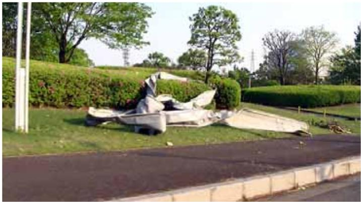
竜巻に伴う突風等で飛ばされた金属製飛来物。工業団地内の各所に散在していた。
