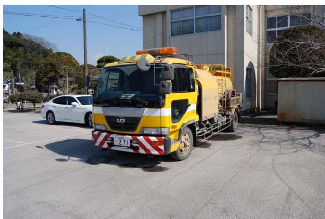
排水溝にたまった降灰を除去するための 排水溝清掃車
