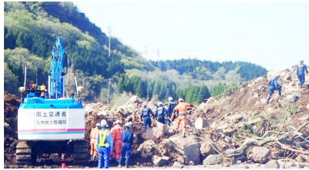
写真4 遠隔操作式バックホウによる 搜索活動支援
