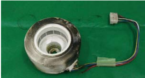
ステータ内面の状況
