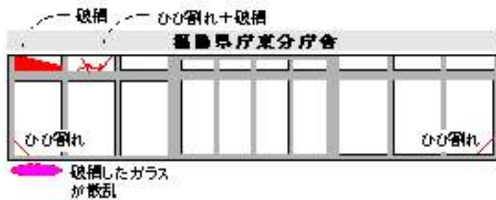
図 5.4-3 東分庁舎一号館エントランスのガラス被害分布
