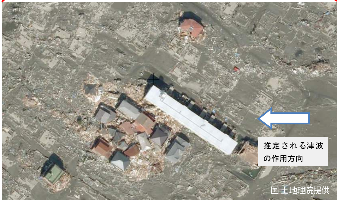
写真 6.4.3-4 津波の作用方向の前面に建つ建築物により津波波力が軽減し、残存したと考えられる例(名取市閑上地区)
