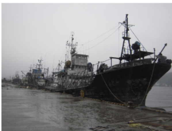
図 7 気仙沼船舶の火災被害
