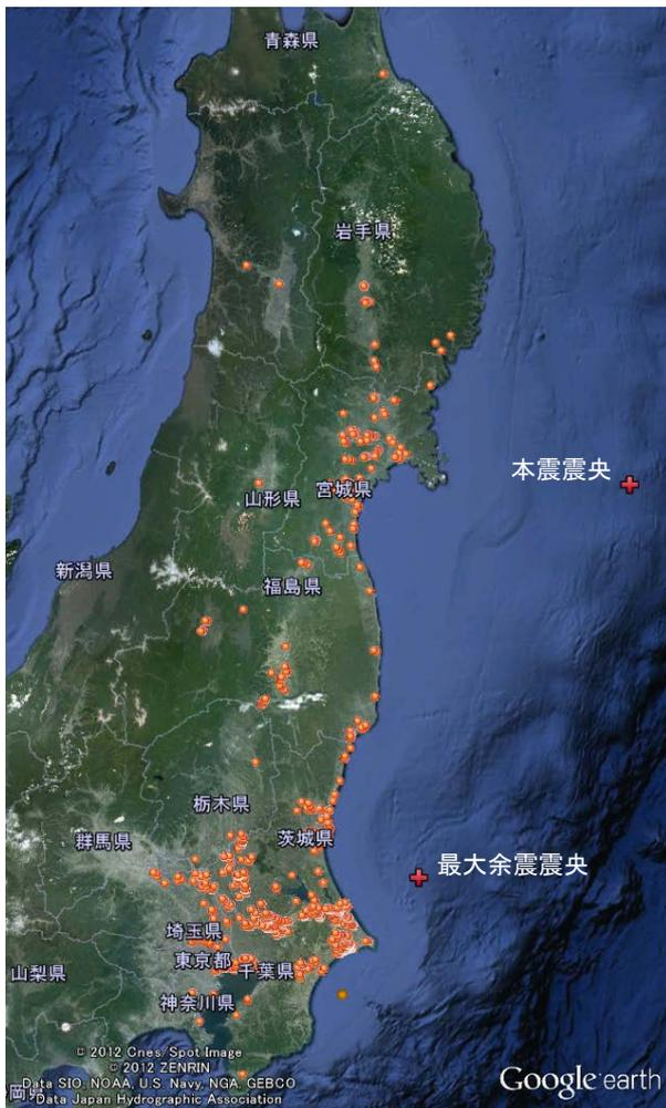
液状化は、大河川の沖積作用による低地や埋立地の面積が大きい関東平野では、沿岸部のみならず内陸部まで極めて多数発生している。これに対して、海岸近くまで山地・丘陵が迫っている東北地方では、少ない。沿岸部に津波が襲来し液状化の痕跡が消失してしまったこともあるが、両地域の地形的特徴の違いが大きく影響したと考えられる。
