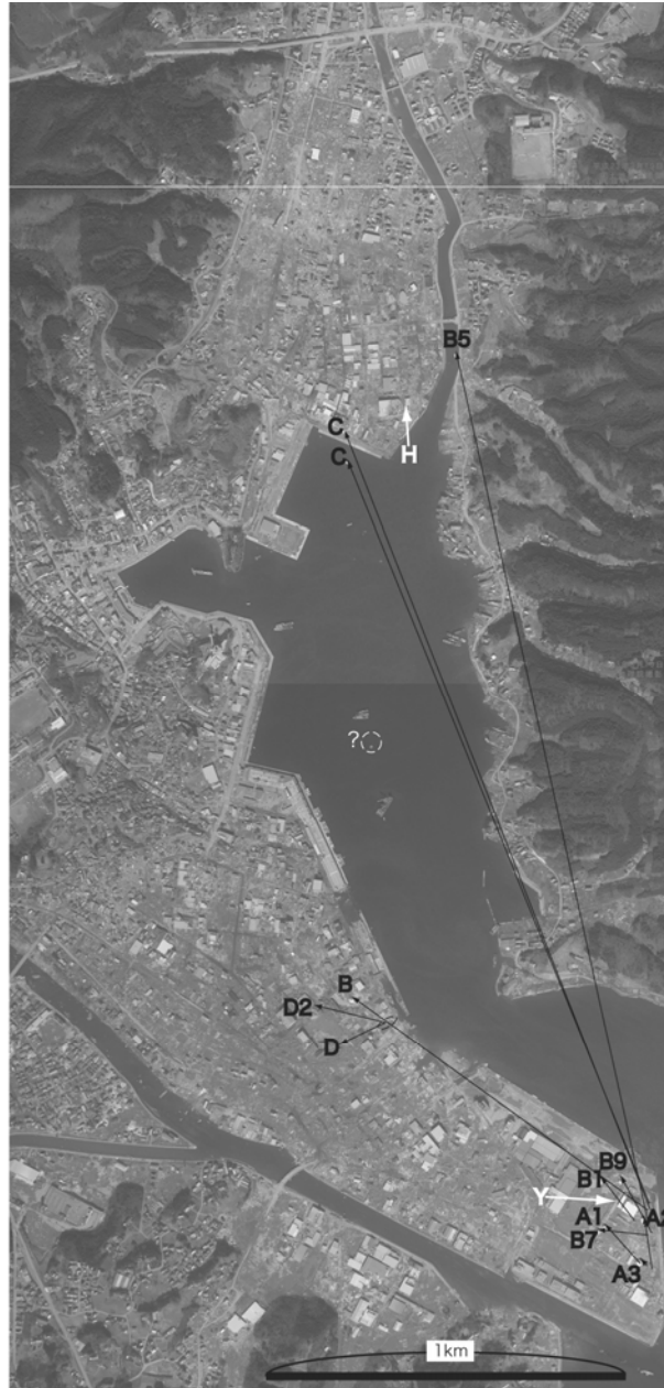
図1 気仙沼漁港周辺に立地していた屋外貯蔵タンクの移動の状況
