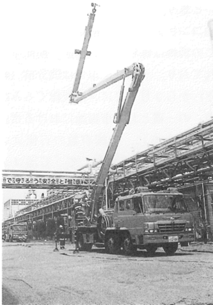
写真2 大型高所放水車による訓練
