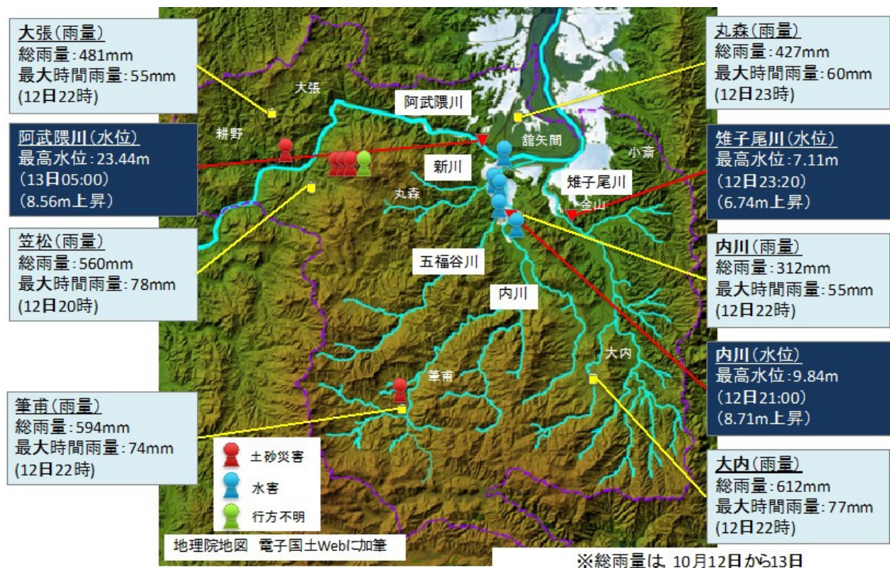
図1 令和元年東日本台風における犠牲者の発生場所及び河川水位、降雨量等
