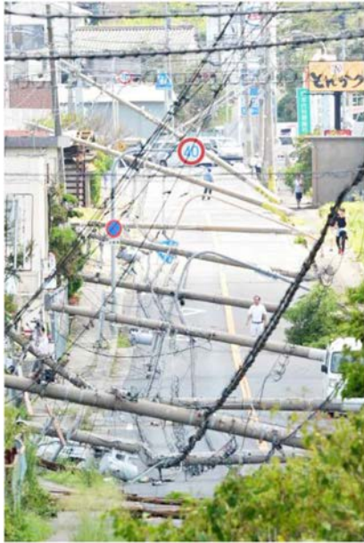
写真7 折損・倒壊した電柱（左：大阪府泉南市、産経新聞社産経フォト 9) 、右：大阪府泉南市、著者撮影）
