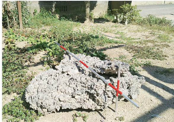
写真1 図3の火災4の位置にアルミ工場から飛来したアルミニウム溶融片 (80cm × 50cm × 15cm、2018年8月7日筆者撮影)
