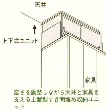
高さを調整しながら天井と家具を支える上置型すき間埋め収納ユニット
