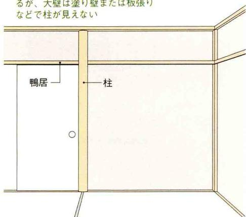
柱がある場合は、家具固定のための金具を柱に取り付ける。柱と離れた位置に家具を置く場合は鴨居に金具を付けるが、装飾的な鴨居もあるので、工務店など専門家に相談した方がよい
